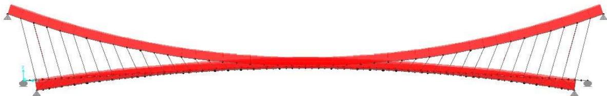
Fig.63 – Diagrama de esforços axiais para a combinação acidental de cheia
