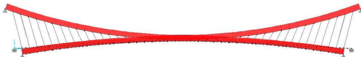
Fig.50 – Diagrama de esforços axiais da combinação permanente
