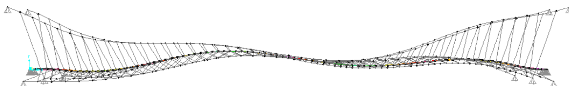
Fig.3 – Imagem do 6º modo vertical da combinação permanente ( f=1,937\text{Hz} )
