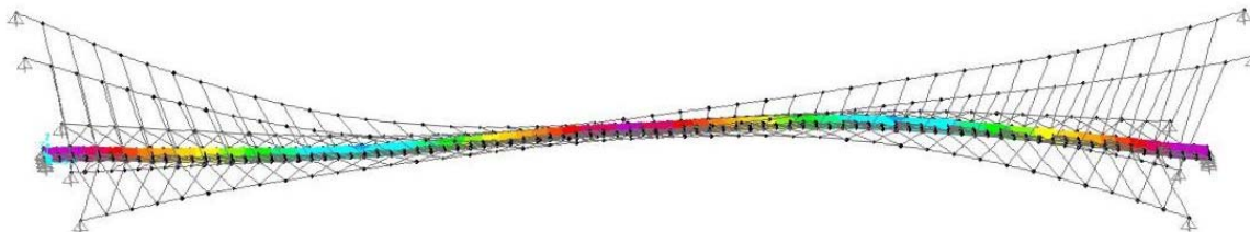
Fig.2 – Imagem do modo de frequência mais baixa (tipo vertical, f=1,082\text{Hz} )
